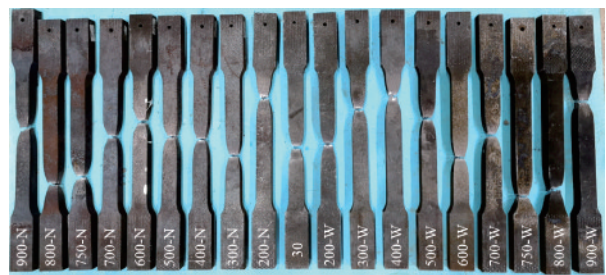
图 3 试验后试件的表观特征及拉伸破坏形态
